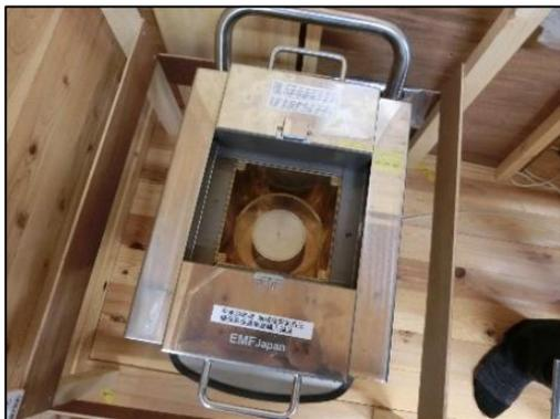
図9 EMF211型 ガンマ線スペクトロメータ
