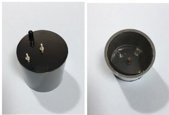
図-2 密閉型GM管のトップと内部
