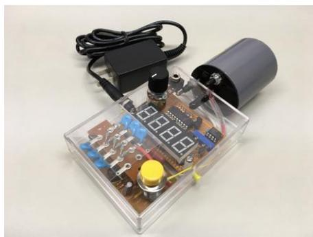
図-1 7セグメントLED表示型とGM管
